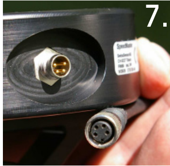
Datenkabel in Sensor drehend einstecken, anschrauben, nachdrücken
